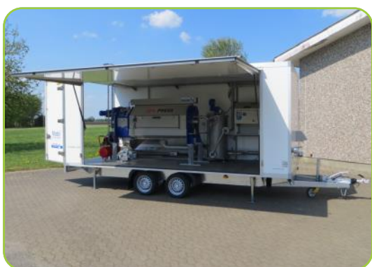
Mobil slamafvanding med IEA skruepresse - Assens Forsyning
