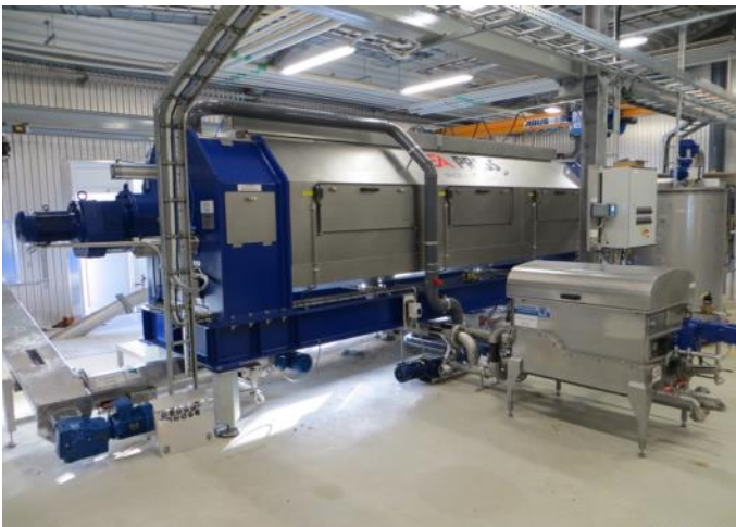
Sundet, Växjö, Sweden - SP-HF09XL screw press and MF600 Microscreen filtrate filtering
